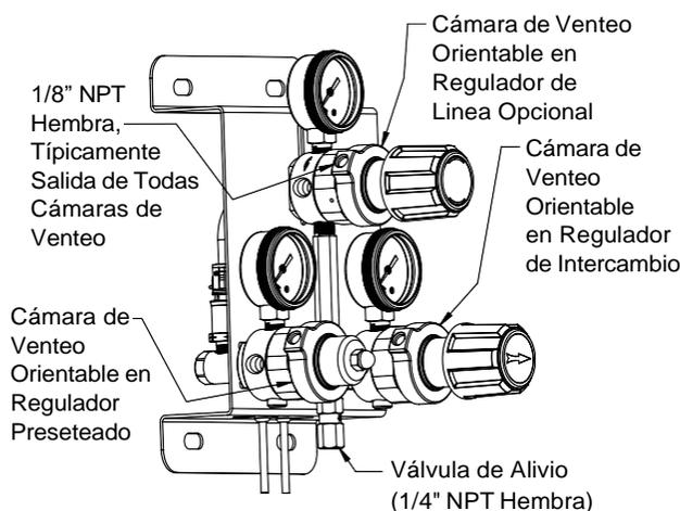
Figure 2 - Localización de la Válvula de Alivio
