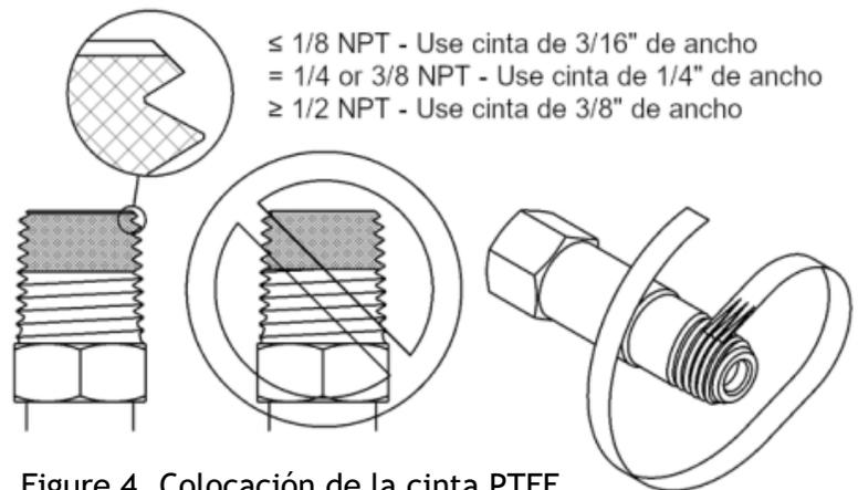
Figure 4. Colocación de la cinta PTFE
